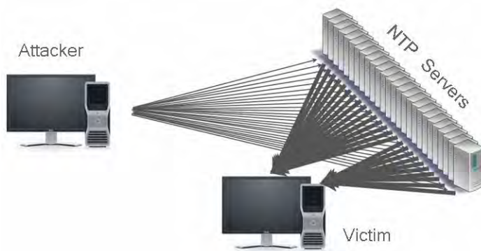
รูปที่ 4 แสดงรูปแบบการโจมตีระบบ โดยเทคนิค Reflection DDoS Attack
