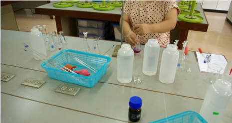
ภาพแสดงการไทเทรตน้ำดิบและน้ำอ่อนทุกชั่วโมงเพื่อหาค่าความกระด้างของน้ำ
