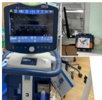
ภาพที่ 1 เครื่องช่วยหายใจและภาคส่งสัญญาณ Wi-Fi
