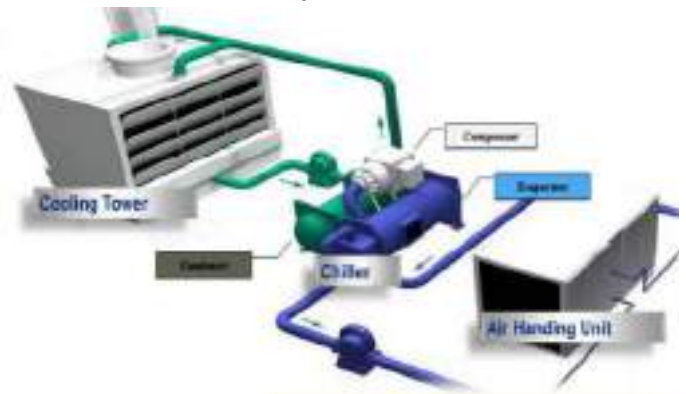
รูปภาพที่ 2 แสดงเครื่องปรับอากาศแบบรวมศูนย์
