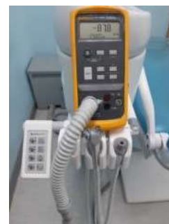
รูปภาพที่ 3 แสดงการวัดแรงดูด High Volume Suction
