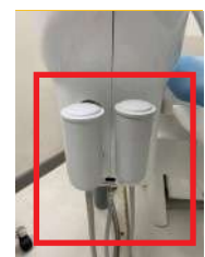
รูปภาพที่ 6 แสดงการติดตั้งชุดกระบอกสร้างแรงดูด (Air tank suction) และกระบอกกรองเศษวัสดุ (Filter Case Suction)
