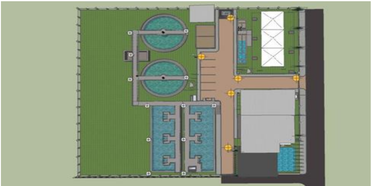
เฟสที่ 3 ประกอบด้วยถังเติมอากาศ 2 บ่อ และบ่อดกตะกอน 2 บ่อ และระบบรวบรวมน้ำเสียจากโซนที่เหลือทั้งหมด รองรับน้ำเสีย 6,000 ลบ.ม./วัน
